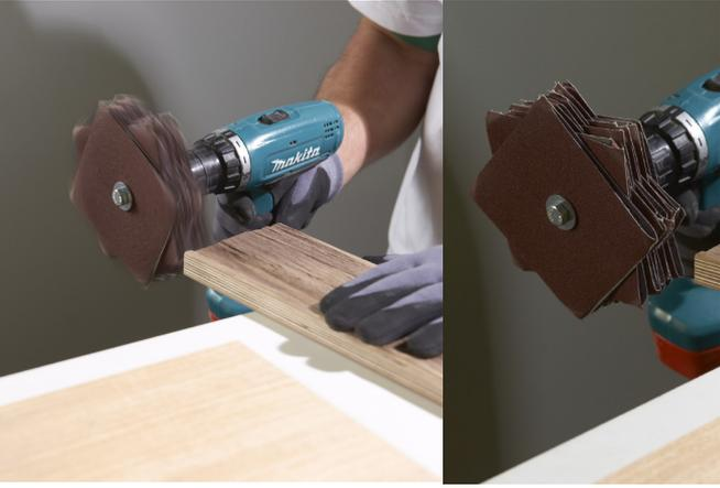
Nach dem Zuschnitt sollten die Kanten gebrochen und entgratet werden. Hier hilft eine einfache und simple Werkzeugidee:
