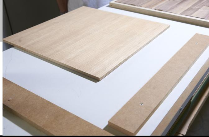
Nach dem Zuschnitt sollten die Kanten gebrochen und entgratet werden. Hier hilft die einfache und simple Werkzeugidee, wie vorstehend beschrieben
