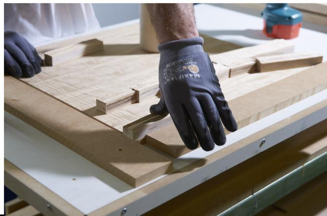
So werden Riegel für Riegel auf der Trägerplatte montiert. Wichtig ist auch in den Quer- und Längsstößen Leim anzugeben.
