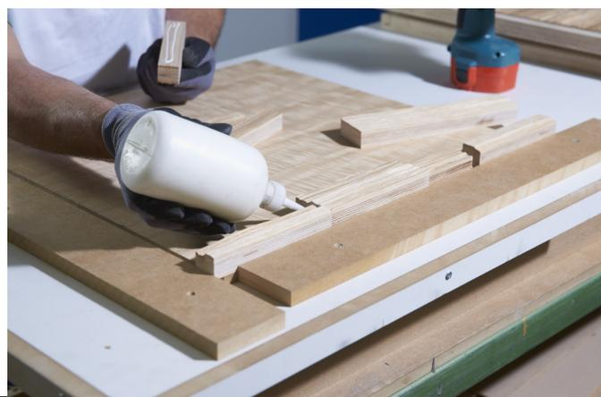
Um ein möglichst ungleichmäßigen Strukturverlauf zu erhalten, sollten die Längen und Breiten der Riegel möglichst unterschiedlich gewählt werden.  $\frac{1}{2}$  -  $\frac{1}{2}$ , oder  $\frac{1}{3}$  –  $\frac{2}{3}$  Versetzungen in der Horizontalen steigern die Wirkung der Struktur. Es ist auch hier darauf zu achten, unterschiedlichen Strukturverläufe zu mischen.
