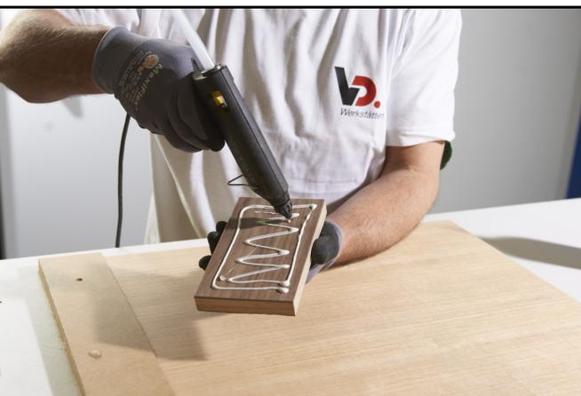
Rückseitig Leim auftragen und in der Ecke des Anschlags beginnend die Spaltholzriegel auf der Trägerplatte montieren. Ein punktueller Auftrag von Heißkleber hilft die Riegel schneller zu fixieren. Dabei die Riegel bis zum Aushärten des Klebers kurz andrücken.
